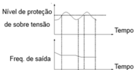
Fig.6-31 Proteção de sobretensão
