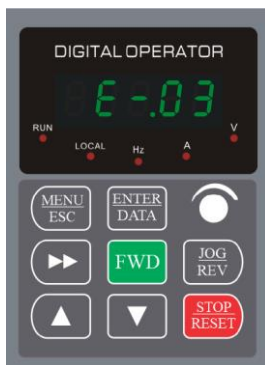
Fig. 4-5 Modo de exibição de alarme ou falha
