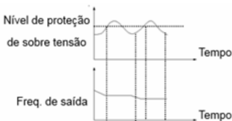
Fig.6-31 Proteção de sobretensão
